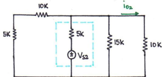
$$\text{SERIES } 10\text{K} + 5\text{K} = 15\text{K}$$
