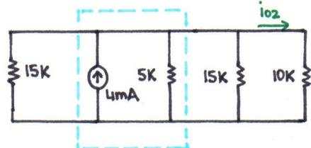
$$R_{\text{EQ}} = 15\text{K} // 5\text{K} // 15\text{K}$$
